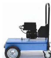
Napęd drutu pchająco- ciągnący na wózku
